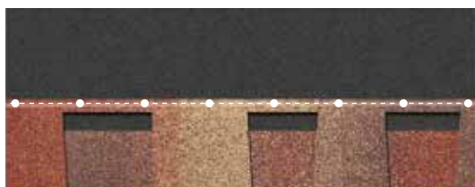
Рис. 5. Схема расположения гвоздей при монтаже Döcke PIE DRAGON.
